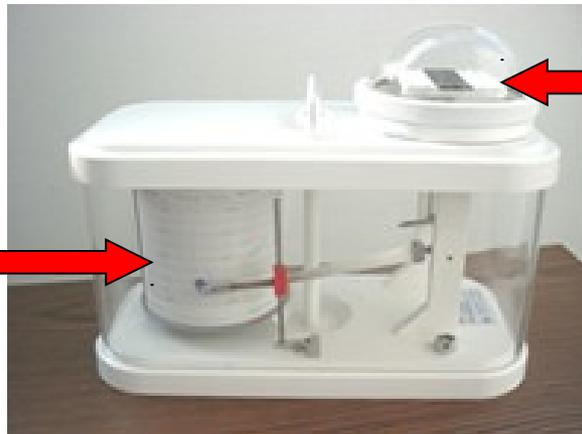
Placas bimetálicas, cobertas por uma cúpula de vidro ou quartzo, que impede que as ondas longas atinjam as placas
